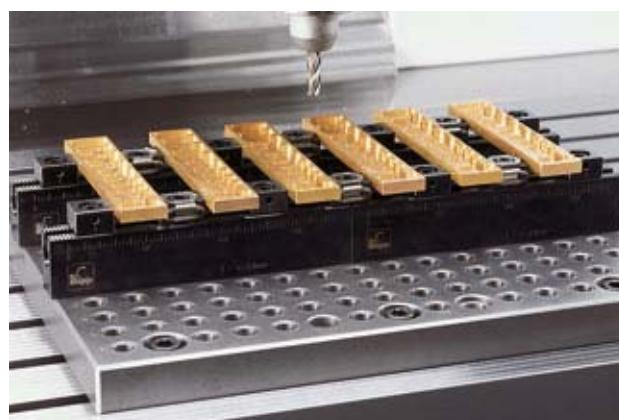
Placa modular en combinación con un sistema de fijación múltiple
